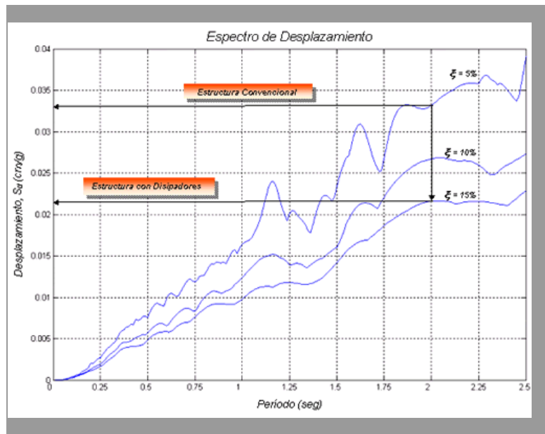
Espectro de desplazamiento para el registro de Lillole (1985) con amortiguamientos de 5, 10 y 15%
