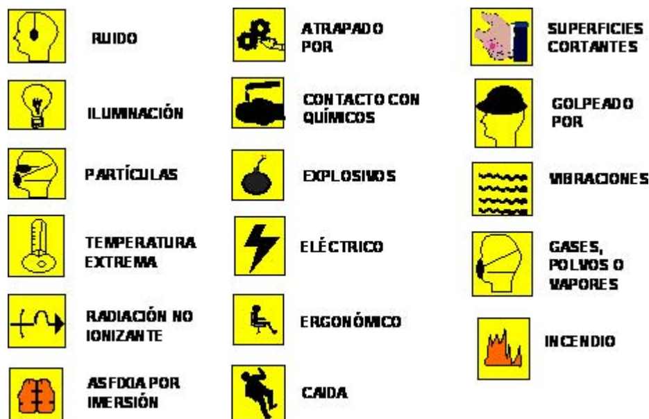
Figura 1. Ejemplo de la simbología utilizada en la construcción de mapas de riesgos
